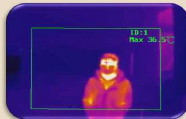
Détection rapide de la température corporelle avec alarme de température anormale (image contextuelle / avertissement audio)
